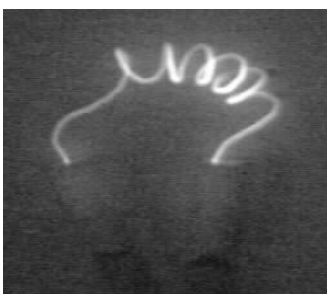
CrNi-Draht 0,2mm \varnothing ; U = 12V , I = 1A Aufnahme mit Video – Kamera keine Beleuchtung
