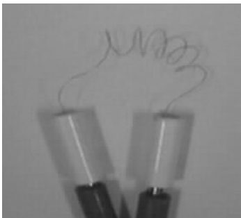
CrNi-Draht 0,2mm \varnothing ; U = 12V , I = 1A Aufnahme mit Video – Kamera Tageslicht
