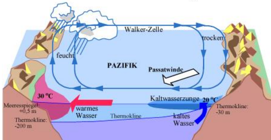
Abbildung 1: Bildungswiki Klimawandel: Die Zirkulationsverhältnisse bei „normaler“ Wetterlage, Quelle: http://wiki.bildungsserver.de/klimawandel/index.php/Datei:ENSO-wetterlage.jpg (Lizenz: CC BY-NC-SA)
