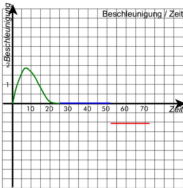
Der Verlauf der Beschleunigung folgt aus dem Verlauf der Geschwindigkeit (linke Abbildung).
