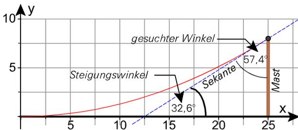
Die Parabel kann beispielsweise so ins Koordinatensystem gelegt werden, dass der Scheitelpunkt im Nullpunkt liegt. Dann stehen die Masten bei  $x = -25$  und bei  $x = 25$ , also 50 Einheiten auseinander. Als Parabel muss dann eine gestauchte Normalparabel  $p$  gewählt werden mit  $p(x) = a \cdot x^2$ , sodass gilt  $p(25) = 8$ , also  $a = 8/25^2 = 0,0128$ .
