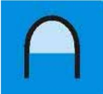
Die Taucherglocke ist ein Behälter, der mit Luft gefüllt ist und durch sein Gewicht – trotz der Luft im Inneren – im Wasser nicht aufschwimmt, sondern absinkt. Sie ermöglicht es, sich längere Zeit unter Wasser aufzuhalten. Ein unten offener Holz- oder Metallkasten hängt an einer Eisenkette.
